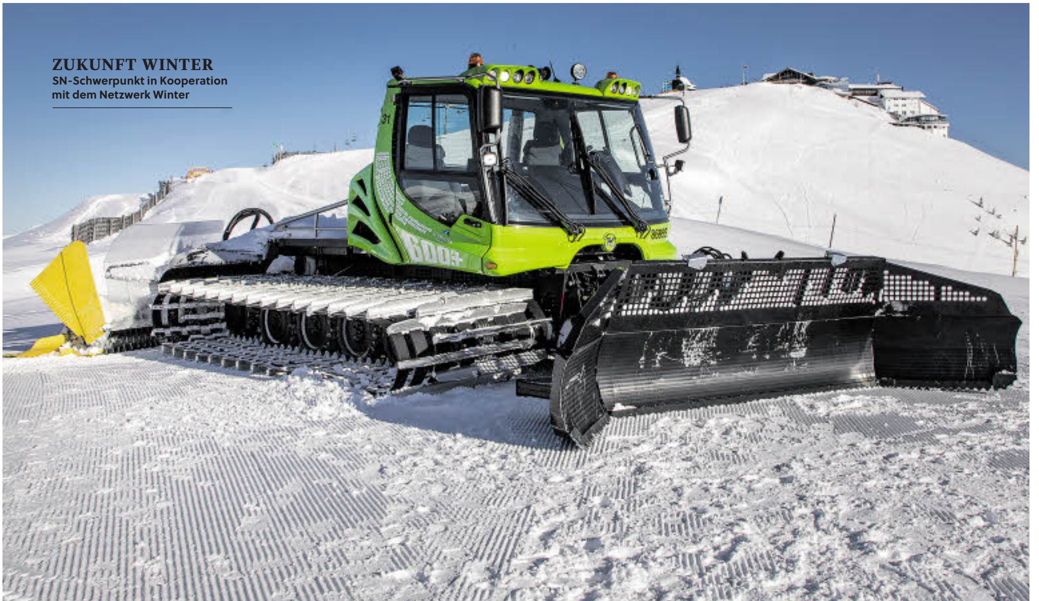
Die grüne Pistenraupe ist mit einem dieselelektrischen Hybridantrieb unterwegs.
